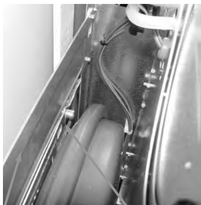
Поперечная траверса на раме и монтажная планка
